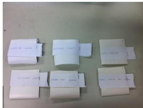
Detalle de la prueba de envejecimiento acelerado
