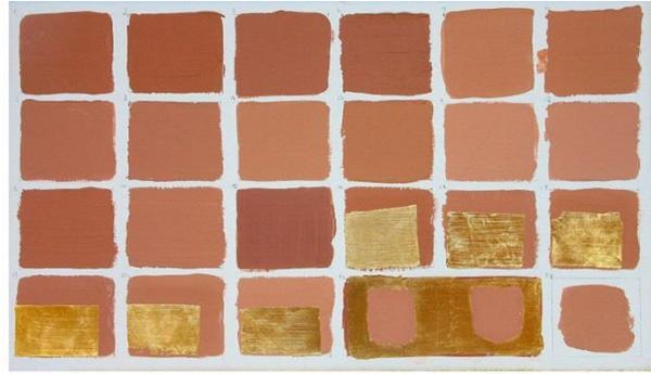
b. Probetas de arpillera después de envejecimiento acelerado
