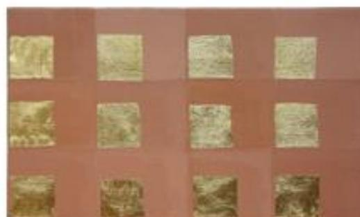
b. Probeta de algodón después de envejecimiento acelerado
